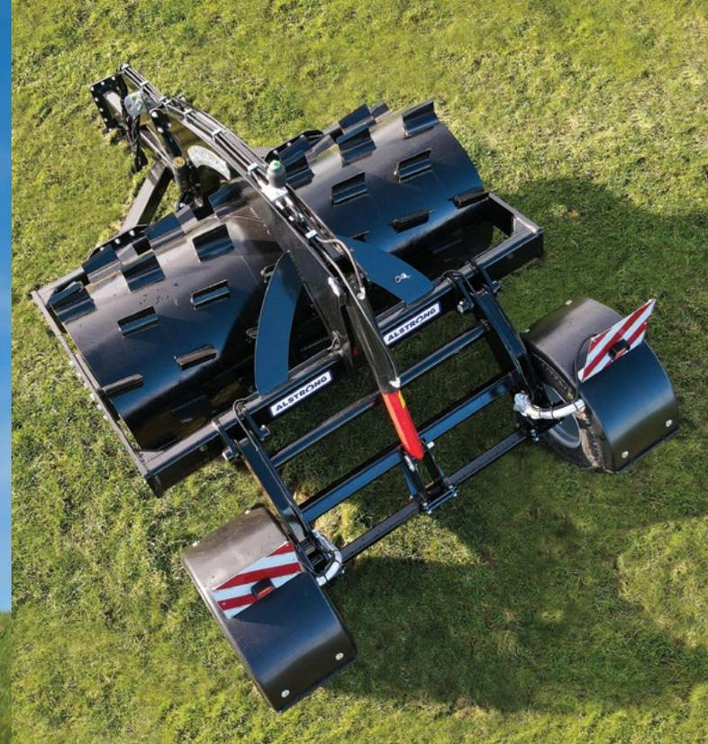
Die Alstrong-Belüfter wurden nicht nur zur Belüftung der oberen Grünlandsschichten konstruiert, sondern können aufgrund ihres einmaligen Klingen-Designs und ihres Eigengewichts die härteren Bodenschichten bis zu 30 cm tief aufbrechen, ohne dabei eine Störung des Bodens oder eine Unterbrechung des Weidesystems zu verursachen.
